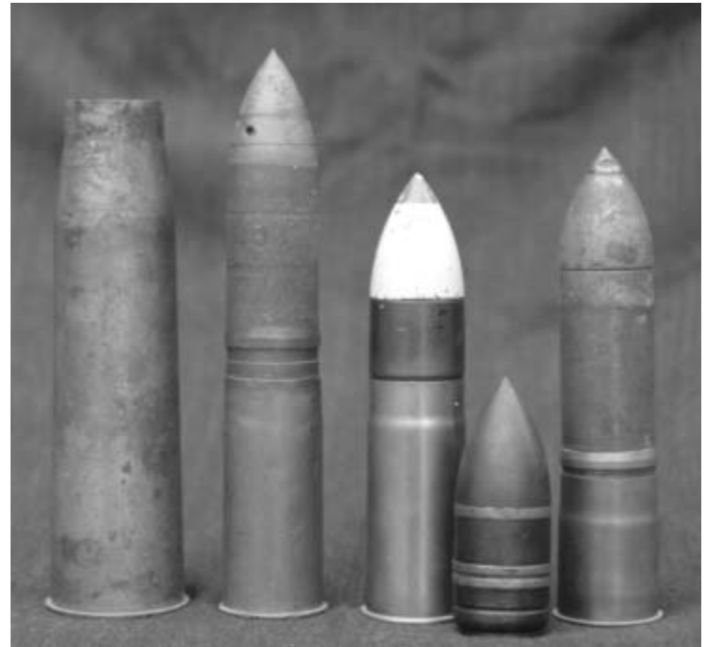
Bossolo di 37/40, cartuccia da 37/20,6, cartuccia da 37x94 Hotchkiss con sotto una variante costruttiva della granata, per ultimo, di lato, un 37 F.
